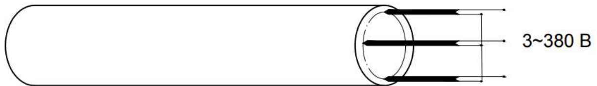
Рисунок 4.19 – Эскиз секции трубчатого электроподогревателя
